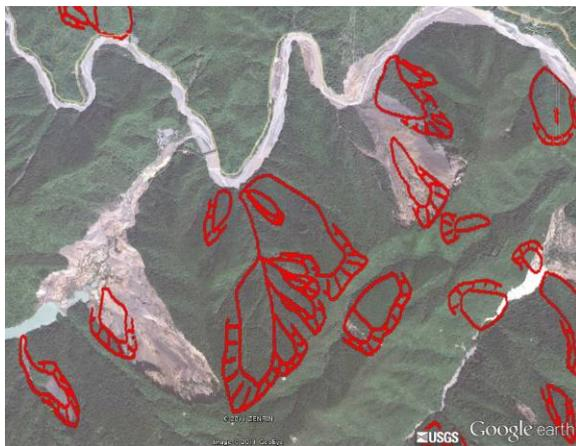
写真-11 赤谷・川原樋の深層崩壊と地すべり地形(GE)
