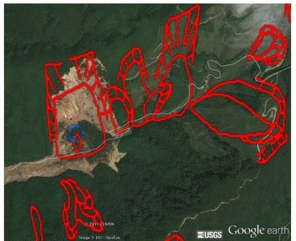
写真-5 田辺市熊野の深層崩壊と地すべり地形(GE)
