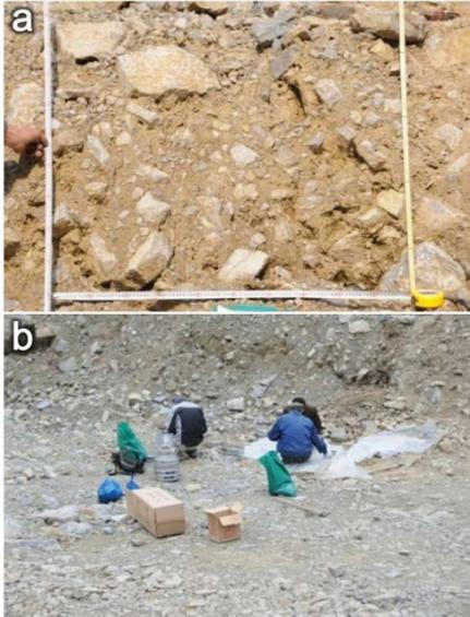
写真-3 (a) 写真による粒径の計測；(b) 篩による粒径計測
