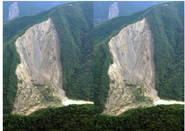
写真-12 長殿谷の深層崩壊の立体視写真
