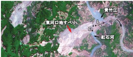
写真-4 東河口付近の地すべりと地すべりダム (黄より)。C, L: 表面波探査測線; ▽: 微動アレイ観測位置
