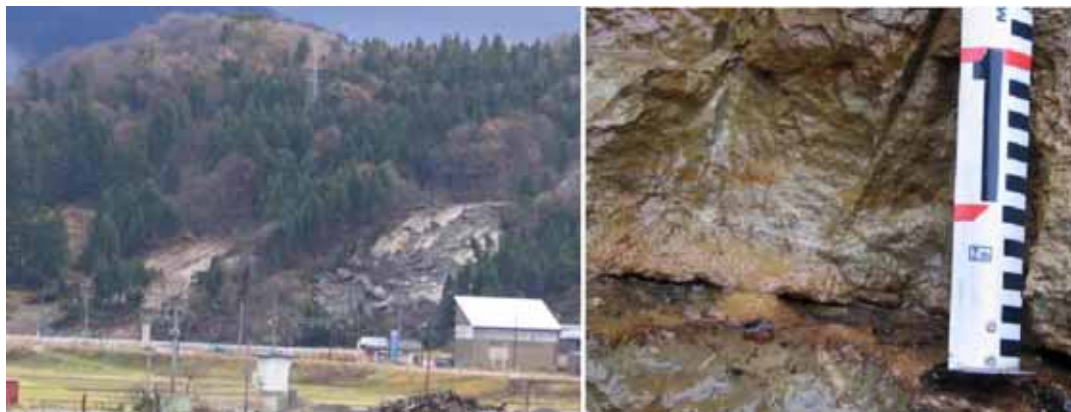
図 10 白岩南方の崩壊．北東を望む．左：図 9 の北側 2 つの崩壊が見える．右：すべり面の形成された凝灰岩．水が浸出している．
